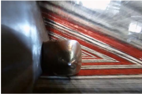
Abbildung 22: Darstellung eines Schiffchens, das sich zwischen angehobenen Kettfäden bewegt. Das Foto ist Eigentum von Textulting GmbH.
