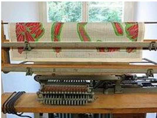
Abbildung 5: Patrone auf Kartenschlagmaschine aufgespannt. Das Foto ist Eigentum von Texulting GmbH.
