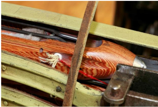
Abbildung 20: Schiffchen mit Schussfaden. Das Foto ist Eigentum von Texulting GmbH.
