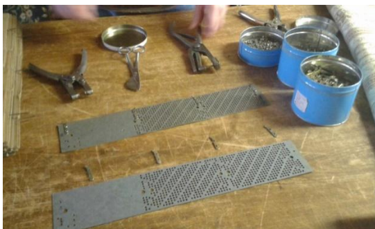
Abbildung 6: Einzelne Lochkarten --<eine Lochkarte = ein Schuss. Das Foto ist Eigentum von Texulting GmbH.
