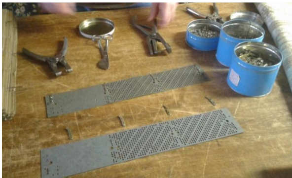
Slika 6: Proces izdelave kart za žakarski stroj. Fotografija je last podjetja Texulting GmbH.
