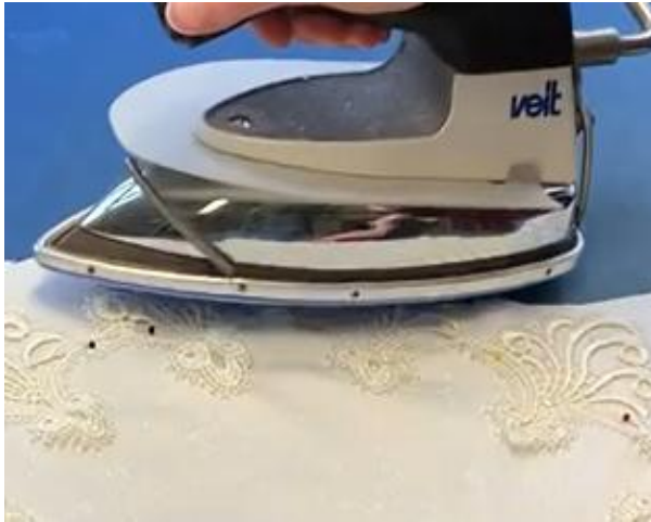
Slika 3: Ko so vezenine v želeni obliki pritrjena na izbrano blago, odstranimo papir. Položene vezenine so primerne za likanje s katerim jih dodatno fiksiramo na podlago. Nato sledi pritrjevanje vezenin na blago s tehniko šivanja. Fotografija je last podjetja Texulting GmbH.
