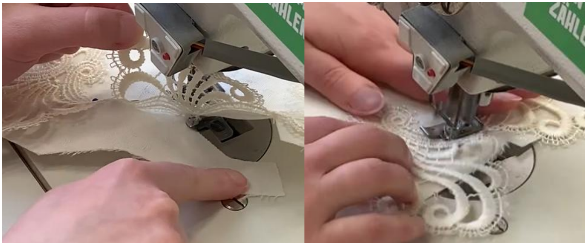
Slika 4: Vezenino se prišije na svoje mesto, odvečen material se odreže. Fotografija je last podjetja Texulting GmbH.
