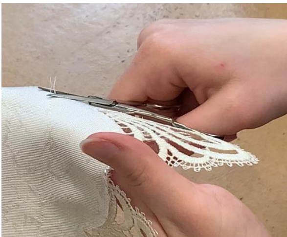
Slika 5: Rezanje odvečnih niti po končanem šivanju. Fotografija je last podjetja Texulting GmbH.
