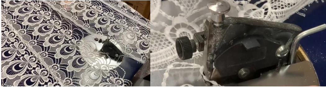
Abbildung 7: Messer für Trennen von Stickereibordüren. Das Foto ist Eigentum von Texulting GmbH.
