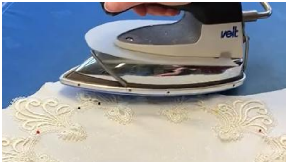
Abbildung 3: Nachdem die Stickerei auf dem Gewebe festgesteckt wurde, wird das Papier entfernt und gebügelt, damit alles glatt ist vor dem Annähen. Das Foto ist Eigentum von Textulting GmbH.
