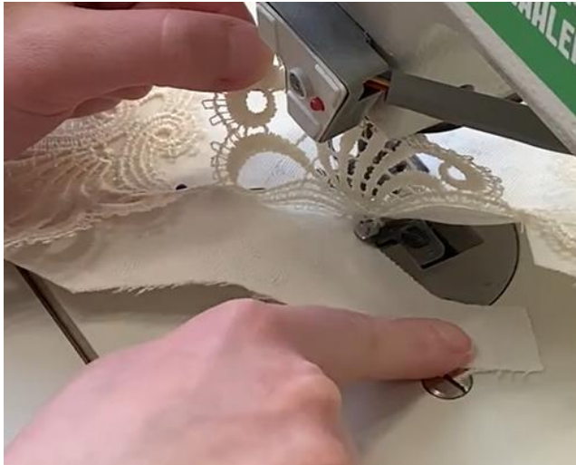
Abbildung 4: Festnähen der Stickerei und der Untergrund wird mit einem scharfen Messer zurechtgeschnitten. Das Foto ist Eigentum von Texulting GmbH.
